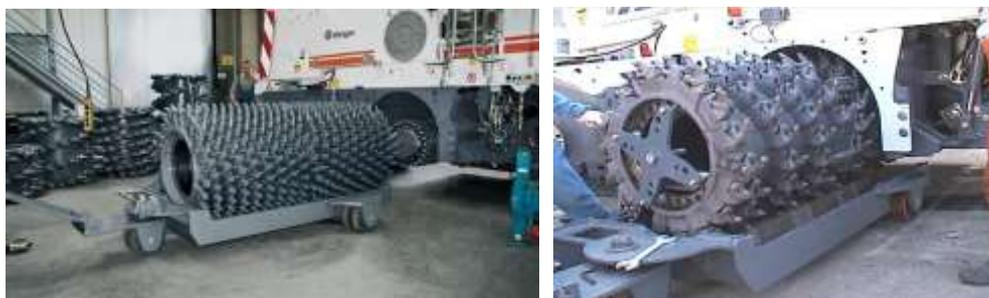
写真-10 切削ドラム交換状況
